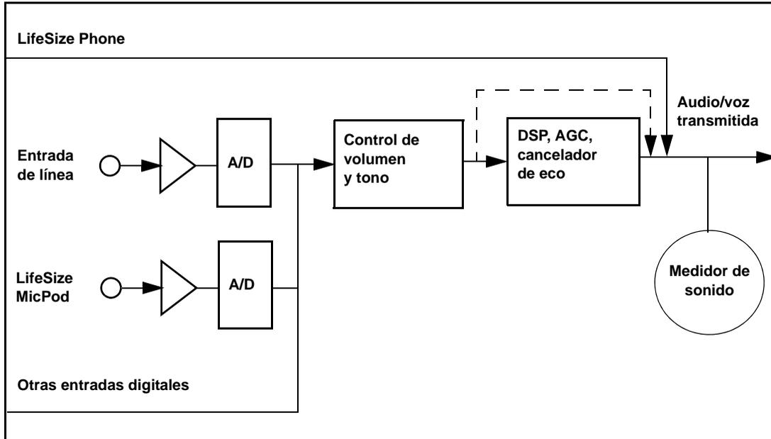
La línea de puntos muestra la ruta de audio cuando *Entrada de micrófono (sin AEC)*, *Entrada de línea 1 (sin AEC)* o *Entrada de línea 2 (sin AEC)* se seleccionan como micrófono activo. Este modo es útil para configurar las ganancias del sistema pero no debe usarse nunca durante las llamadas a menos que la instalación incluya entradas de audio con AEC externo. Si no se utiliza AEC puede producirse eco.
