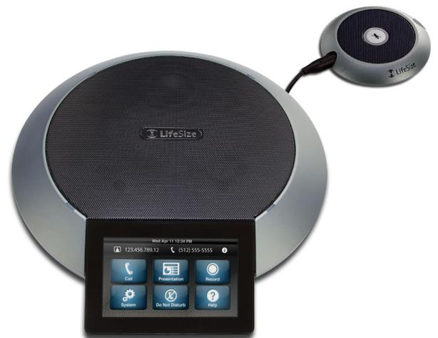
*LifeSize Digital MicPod funktioniert nur mit LifeSize Phone (2. Generation) über zwei LifeSize Link-Anschlüsse.*
