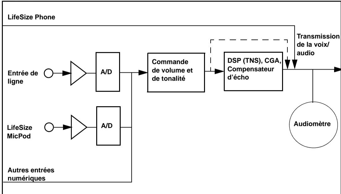
La ligne pointillée illustre le chemin audio lorsque l'option *Entrée du microphone (sans CEA)* ou *Entrée de ligne (sans CEA)* est sélectionnée comme microphone actif. Ce mode est utile pour paramétrer des gains du système mais ne doit jamais être utilisé pendant les appels à moins que l'installation ne comprenne des entrées audio avec CEA externe. Un écho peut se produire lorsqu'aucun CEA n'est utilisé.
